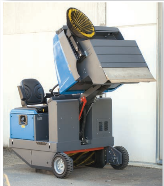
Sollevamento idraulico del contenitore rifiuti Hydraulic height dump up for empty
