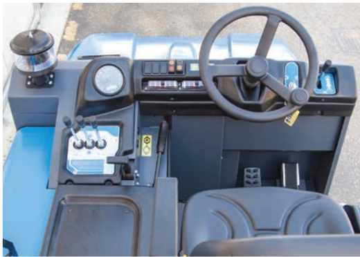
Cruscotto con indicatori luminosi e leve per il controllo idraulico Dashboard with bright indicators and hydraulic control device by levers
