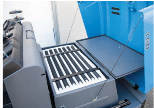
Filtro a sacche in tessuto poliestere con squotifiltro elettrico Fabric dust filter with electric filter shaker
